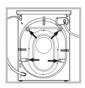
3. Αφαιρέστε τις 4 βίδες προστασίας για τη μεταφορά και το λαστιχάκι με το σχετικό διαχωριστικό, που βρίσκονται στο πίσω μέρος (βλέπε εικόνα).
